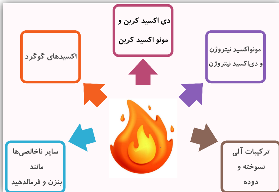
شکل ۳- ترکیبات وارد شده به هوا در اثر سوزاندن گازهای همراه [۳]
